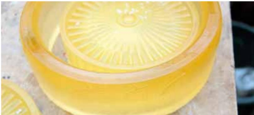
Die Modellfelge wurde im CAD-Programm erstellt und mittels Rapid-Prototyping realisiert. Dabei wird die Form schichtweise aufgetragen und unter UV-Licht gehärtet.
