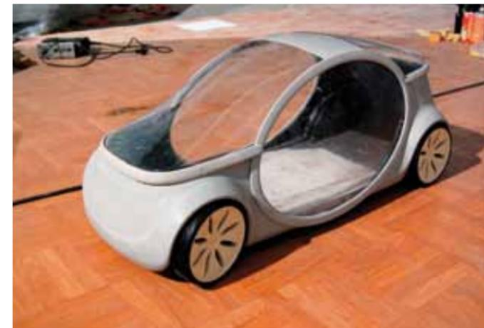
Anhand des Clay-Modells entstand in Handarbeit eine GFK-Abformung. Diese wurde lackiert und mit dem Innenraum und den tiefgezogenen Scheiben versehen.
