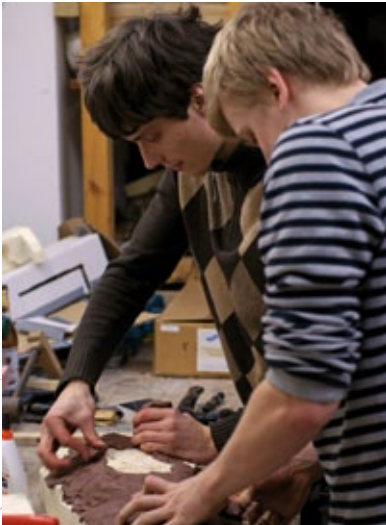
Aufschichten auf einen Schaumkern
