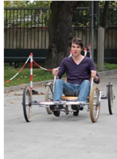
Testfahrt mit dem Fahrwerksmodell, um das Lenkprinzip zu beurteilen.
